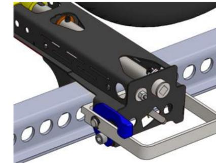
5. Pase la correa larga con la hebilla sobre la llanta y sujétela a con la punta de la correa corta. Coloque los tacos en la banda de rodadura. El gancho debe quedar opuesto a la llanta como se muestra.
